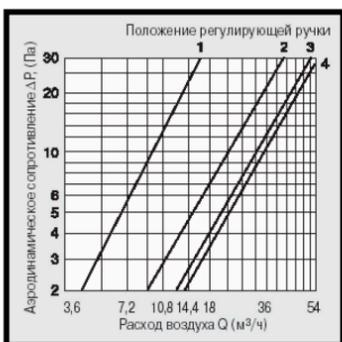
В соответствии с аэродинамическими характеристиками производительность клапана зависит от создаваемого вытяжкой разрежения.
