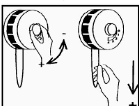
Регулировать поток проходящего через клапан воздуха можно при помощи рукоятки на оголовке клапана или специального шнура, если клапан расположен высоко. На оголовке клапана расположена шкала, указывающая степень открытия клапана. Клапан имеет плавную регулировку вплоть до полного закрытия.
